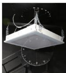
Gonio-Photometer Vermessung Leuchte
