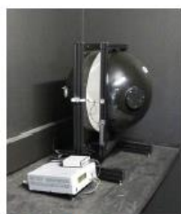
Ulbrichtkugel Vermessung LED
